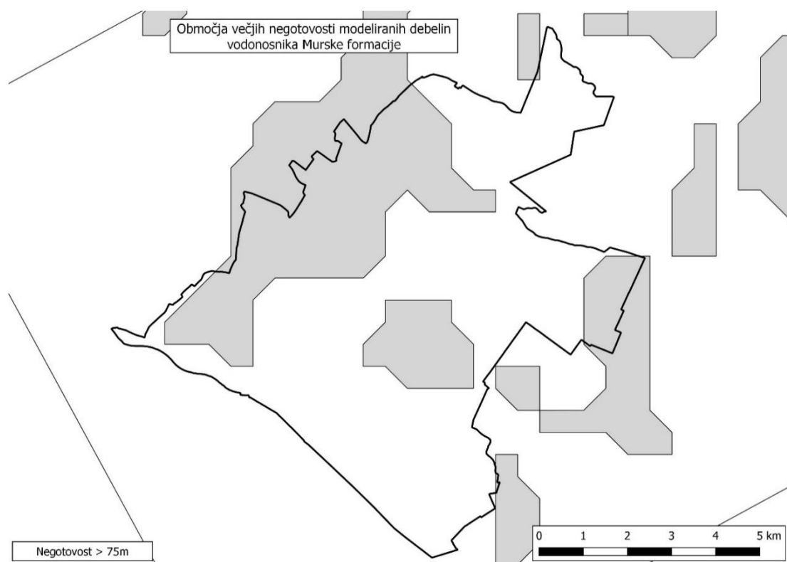
Slika 13: Območja z višjo negotovostjo modeliranih debelin geotermalnega vodonosnika deltnega čela Murske formacije na območju občine Beltinci.
